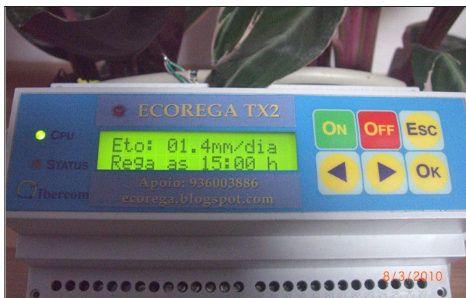
Figura 3. Aspecto geral do controlador de rega, indicando a hora da rega e a dotação calculada pelo método de Hargreaves-Samani.
